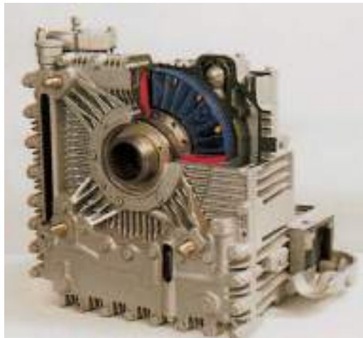
Σχ. 3.20 Υδραυλικός επιβραδυντής.
